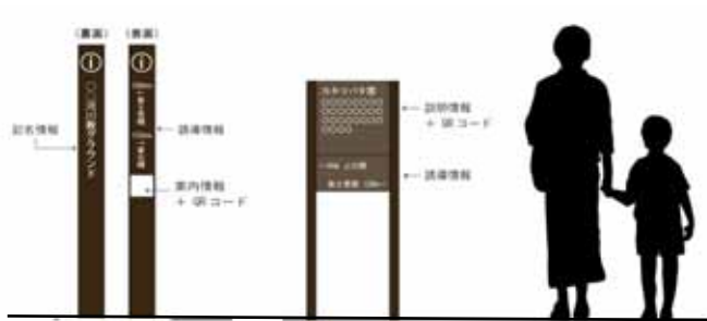
河川空間では避難誘導が可能な案内標示板を設置
